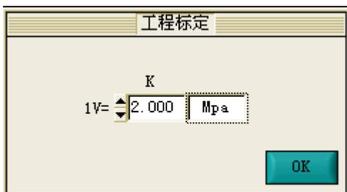
A: 设置每 1V 电压量所代表的物理量，所有单位都将已换算后的物理量显示，自动保存设置。
