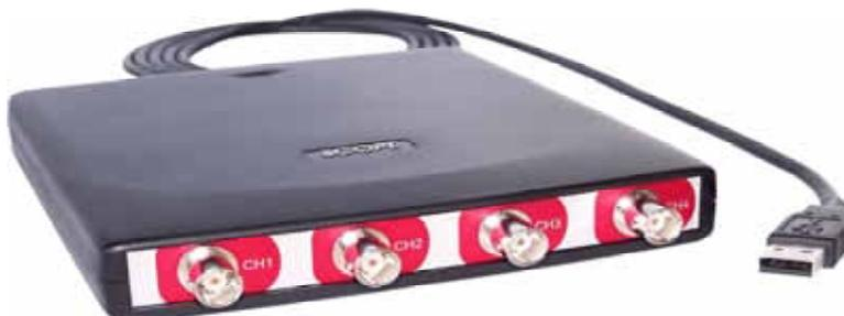
HS4 是一款便携式的多功能的综合测试仪器(它包括：数字多用表，数字存储示波器，频谱分析仪和瞬态记录仪)。作为一款四通道的测量仪器，它的具体指标为 50M 采样每秒，可变分辨率的调节范围是 12-16 位，每个通道的存储深度都是 128K 采样，HS4 是全球第一款不需外接电源，由 USB 2.0 或 USB 1.1 与计算机相连的四通道便携式综合测试仪。
